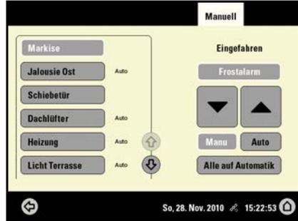
Hier können Sie Antriebe und Geräte direkt bedienen: Wählen Sie über die Tasten mit den Namen links den Antrieb oder das Gerät aus, das Sie bedienen möchten. Die Reihenfolge der Liste können Sie im **System**-Menü verändern.
