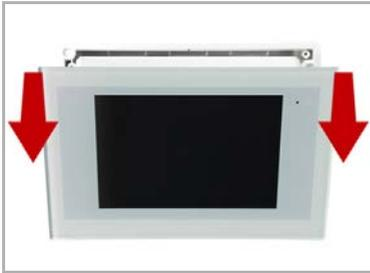
Die Display-Einheit wird von Magneten am Unterputzkasten gehalten. Nehmen Sie das Frontteil ab.
