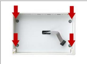
Die Schutzabdeckung im Unterputzkasten ist mit vier Schrauben befestigt. Lösen Sie die Schrauben und nehmen Sie die Schutzabdeckung ab.
