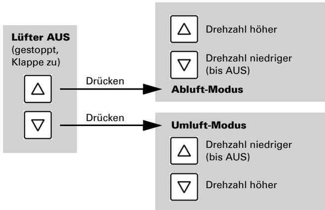
Jedes Mal, wenn der Zustand **AUS** erreicht wird, stoppt die Drehzahländerung automatisch, sodass kein direkter Wechsel zwischen Abluft- und Umluft-Modus möglich ist.
