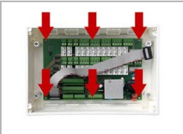
Entfernen Sie zum Montieren des Unterputzkastens die Platine und bewahren Sie sie an einem schmutzgeschützten Ort auf. **Sie darf niemals Staub oder Feuchtigkeit ausgesetzt werden!**
