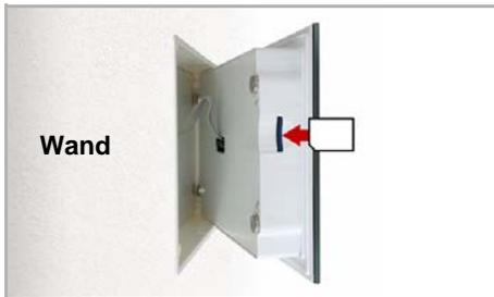
Der SD-Karten Steckplatz befindet sich an der Innenseite des Gehäuses.
