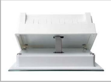
Lösen Sie den Stecker um die Display-Einheit entfernen zu können.
