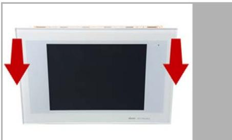
Die Display-Einheit wird von Magneten am Unterputzkasten gehalten. Nehmen Sie das Frontteil ab.
